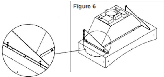
**ÉTAPE 7 :** Demander de l'aide si nécessaire, mettre l'assemblage du revêtement, du ventilateur et des supports de fixation en position et fixer les vis en les étendant au panneau de montage. S'assurer que les supports sont placés fermement dans la fente du trou de la penture et puis serrer toutes les vis (voir la figure 7).
