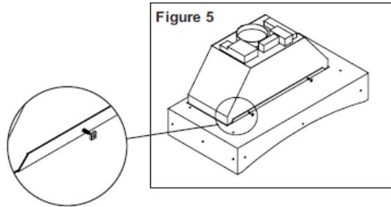
**ÉTAPE 6 :** Fixer les supports de fixation au revêtement avec chacune des quatre (4) vis 10-24 de  $\frac{3}{4}$  po et des écrous. Les serrer seulement à la main cette fois-ci (voir la figure 6).
