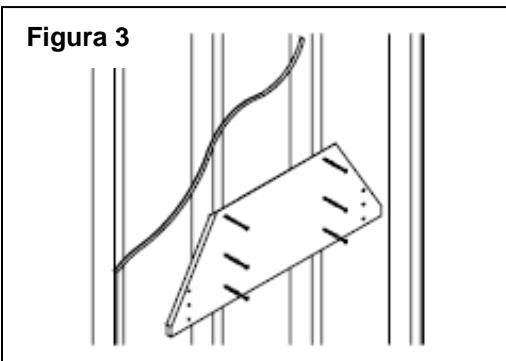
**Advertencia:** El no sujetar este panel a montantes o usar tornillos incorrectos puede causar una falla en el sistema de montaje y lesiones.
