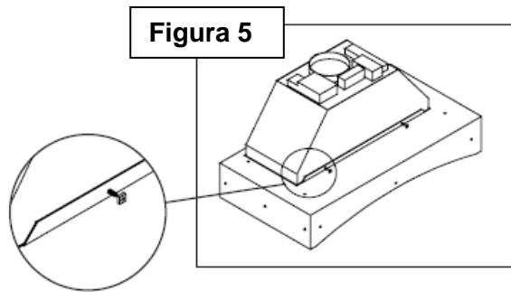
**Paso 6:** Sujete los soportes metálicos de montaje al revestimiento con 4 tornillos y tuercas 10-24 x 3/4". Sólo apriete con la mano en este momento (vea figura 6).
