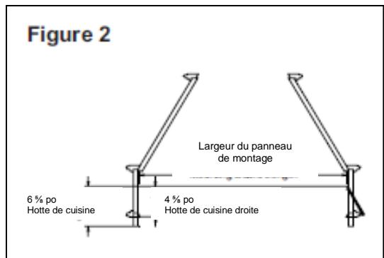
**ÉTAPE 3 :** Visser le panneau de montage au mur en faisant correspondre le bas du panneau de montage à la ligne sur le mur. S'assurer d'enfoncer au moins deux (2) croûts et d'utiliser au moins six (6) vis de grandeur et de largeur suffisante pour l'application (voir la figure 3).
